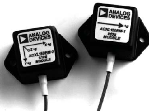
Рис. 8. Одноосевой (справа) и трехосевой модули-акселерометры ADXL150EM-1 и ADXL150EM-3
