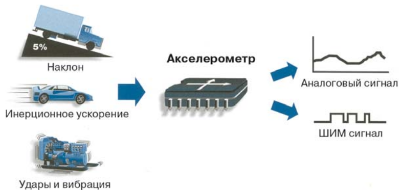
Рис. 4. Применение акселерометров для измерения углов наклона, “инерционного” ускорения, ударов и вибраций
